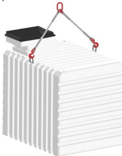
Рисунок 4. Крепление стропой СТП-1
