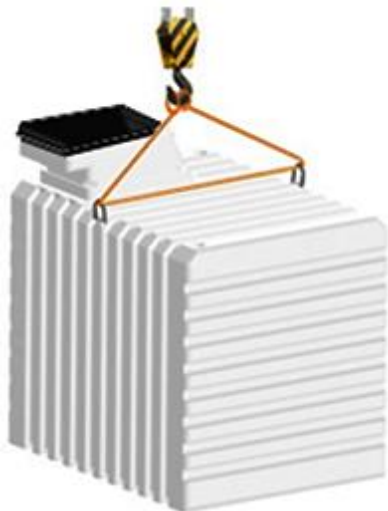
Рисунок 3. Крепление стропой 2СК-1,0
